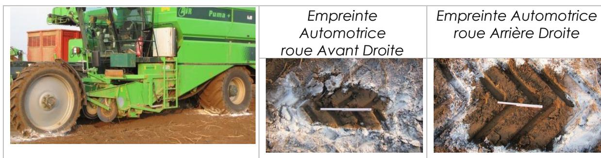
Les mesures des surfaces d'empreintes ainsi que la pesée de la charge par essieu ont permis d'évaluer les contraintes de pression exercées sur le sol en kg/cm<sup>2</sup>.
