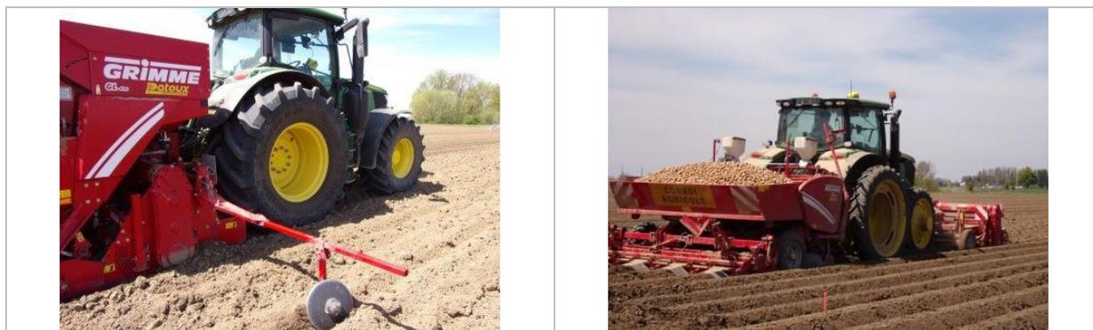
*Les deux types de chantiers de plantation combinée en un passage mis en comparaison à Beuvry (62) diffèrent selon que la préparation de sol s'effectue sur le relevage arrière associée à la planteuse (gauche) ou sur le relevage avant en dissociation de la plantation (droite.)*
