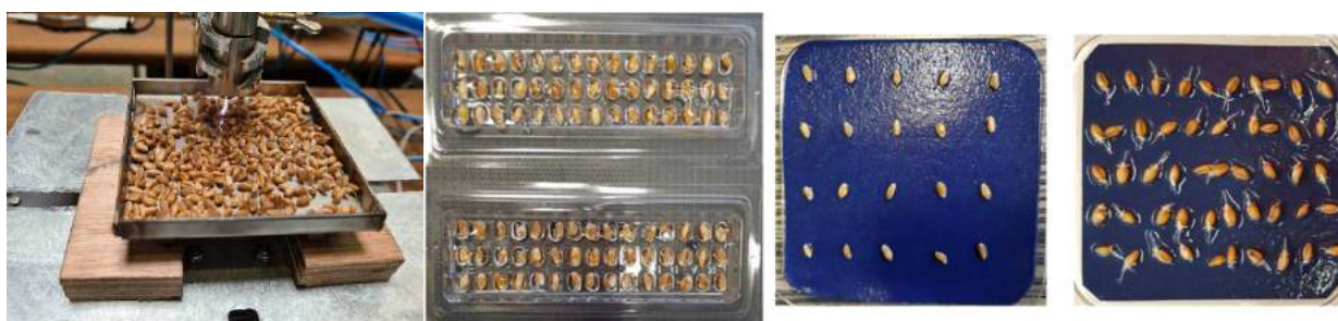
Système d'agitation des graines durant le traitement torche à plasma et trois méthodes testées pour l'induction de la germination (de gauche à droite) : dans des cupules en plastique remplies d'eau, en boîte avec papier absorbant imbibé d'eau 20 grains/ boîte ou la même méthode mais 50 grains/ boîte.
